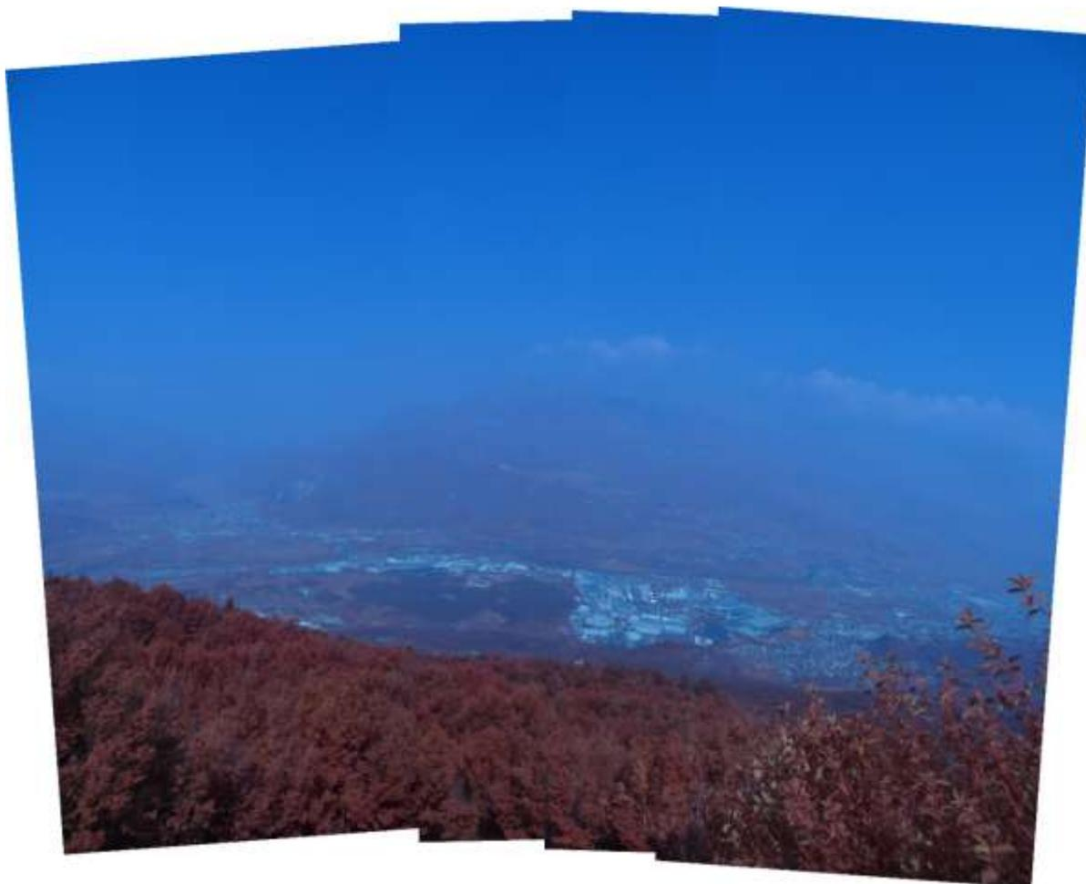
**Fig. 24.** Luglio 2019, postazione Monte Zugna: rappresentazione in falso colore come mosaico di immagini (ogni immagine è frutto della combinazione in sintesi additiva di tre bande: blu, verde, e primo infrarosso). Si possono ricavare poche informazioni a causa dell'intensa foschia.
