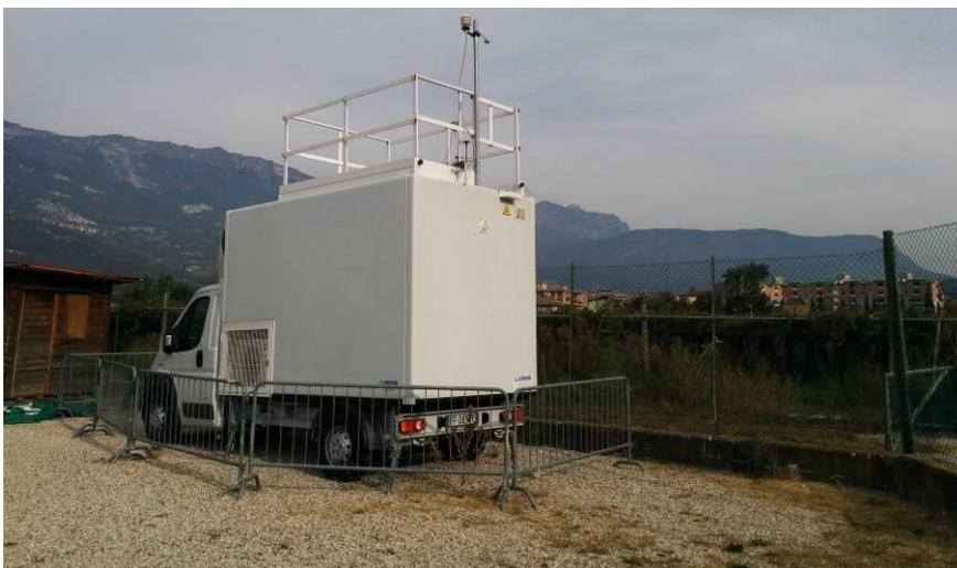
**Fig. 1.** Posizione della centralina di misura Pen3Meteo all'interno del Laboratorio mobile presso l'impianto sportivo di Lizzana.
