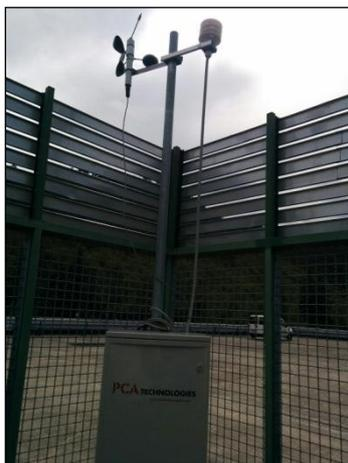
**Fig. 1.** Posizione della centralina di misura Pen3Meteo presso la porzione meridionale del tetto piano del complesso Rovercenter.
