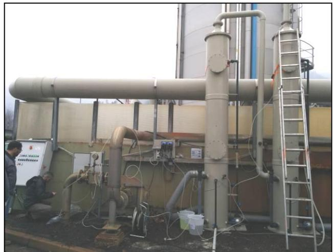
**Fig. 6.** Immagine dell'impianto pilota con installazione (a sinistra) della strumentazione Pen3.
